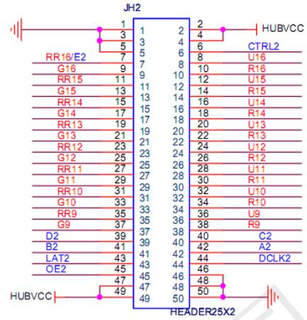
每个50pin插座里面最后一组数据的虚拟红信号在32号工作模式下时输出为译码信号的E信号
