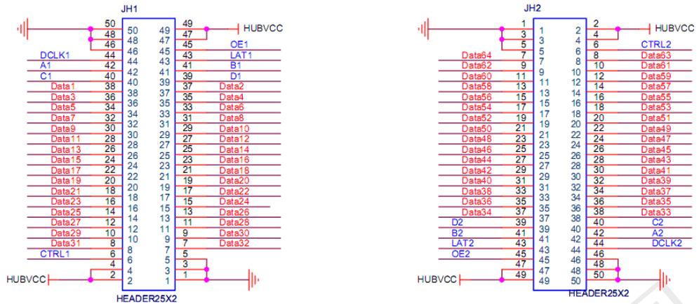
串行模式下共计64根数据线，每根数据线都可以单独驱动一根灯条。
